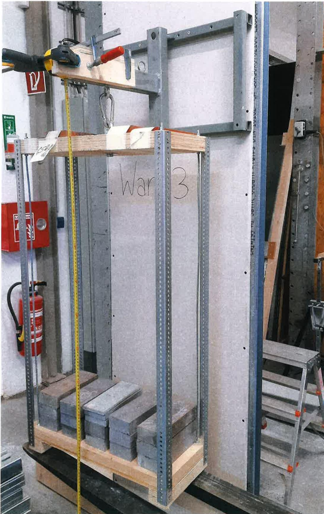
Abbildung A 3 Prüfaufbau: Konsollastprüfung mittels Totlasten und Absenkungsmessung, Wand 3 bei 1,5 kN/m Belastung
